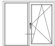
Одностворчатый оконный / балконный блок с глухой частью:
