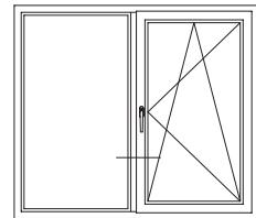
Одностворчатый оконный / балконный блок с глухой частью:
