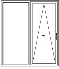
Наклонно-сдвижная дверь (PSK-портал):
