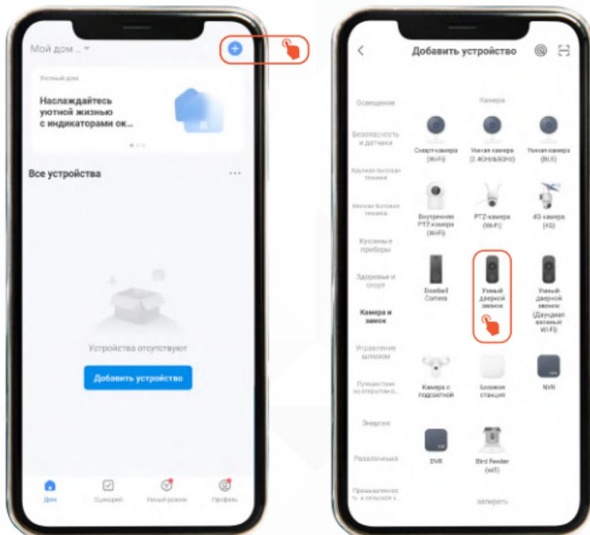
После нажатия «+» выберите тип «Камера и замок» и затем «Умный дверной звонок»
