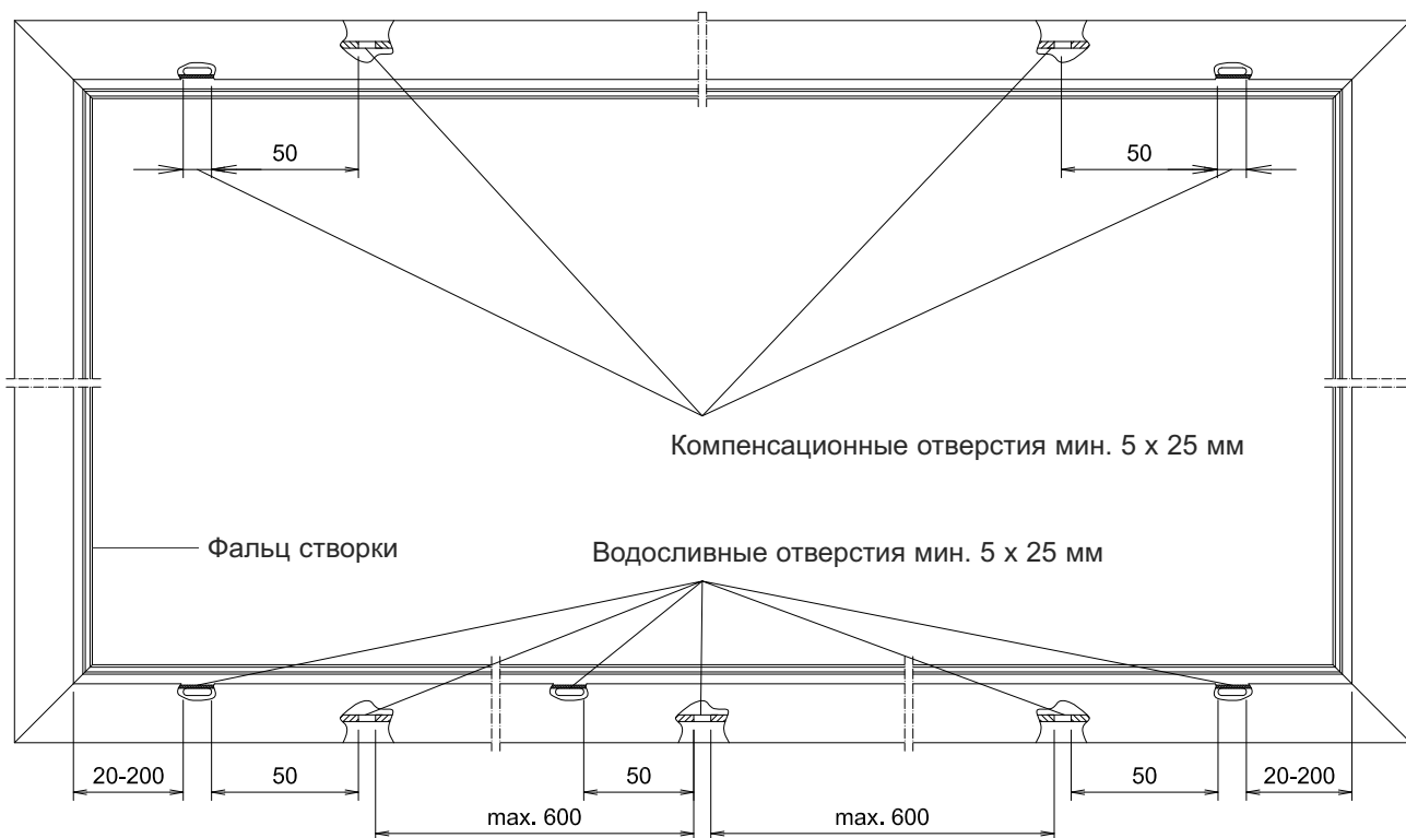
Рис.3 Оконная створка. Вид изнутри.
